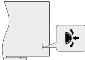
Mit dem Steuerschalter können Sie die Funktionen Programm und Quick Standby-On des Fernsehgeräts steuern.
