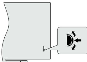
Le commutateur de commande vous permet de contrôler les fonctions de Programmation et de Mise en Veille Rapide du téléviseur.
