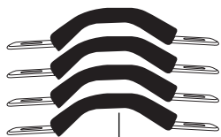
Stator en forme de U (4 pièces)
