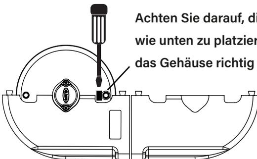
**Achten Sie darauf, die Schlauchschelle wie unten zu platzieren. So lässt sich das Gehäuse richtig verschließen.**
